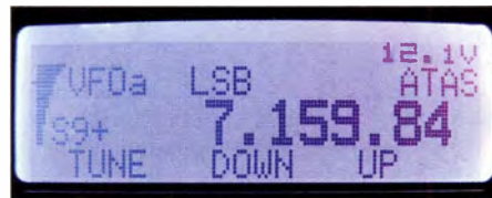
Bild 5: Betriebszustand ATAS (Stand-by) der ATAS-Antenne
