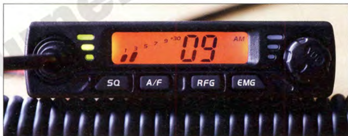
Von den drei Mini-CB-Transceivern am besten ausgestattet: AE 6110 mit S-Meter
