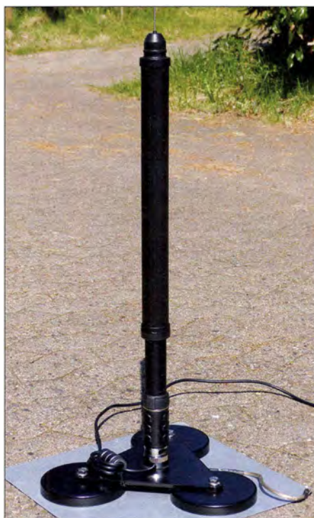
Bild 1: Die Abstimmereinheit der ATAS-120A
