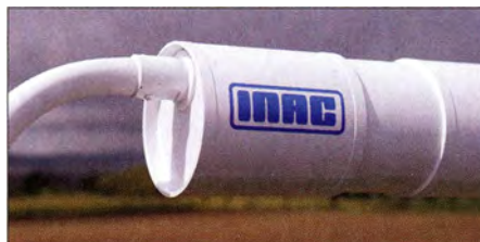
Das oben in den Rahmen integrierte Kunststoffrohr beherbergt wettergeschützt den Abstimmkondensator und den Servomotor.
