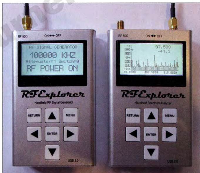
Bild 1: Der Signalgenerator (links) unterscheidet sich äußerlich kaum vom Spektrumanalysator (rechts) aus der gleichen Gerätefamilie. Sein Ausgangssignal ist hier auf 100 MHz und -40 dBm eingestellt.
