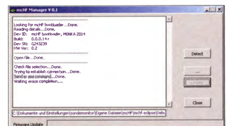
Bild 14: Nur wenige Mausklicks sind nötig, um die Firmware mithilfe des Bootloaders in den Mikrocontroller des mCH -Transceivers zu laden.
