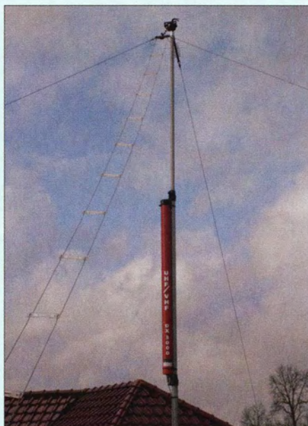
Bild 15: Ein Rundstrahler für 2 m und 70 cm findet auch noch Platz am Mast.
