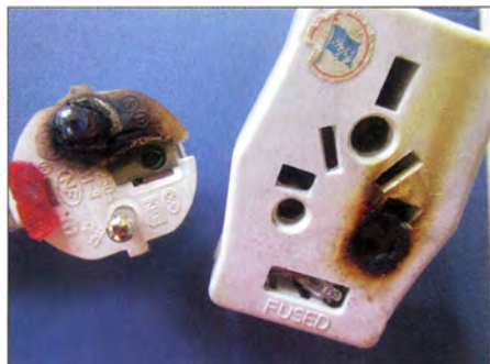
Überspannungsschaden am Mehrfachstecker
