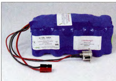
Bild 11: LiFePO 4 -Akkumulator 12V/20 Ah mit separatem Ladeanschluss (r.) – für den Gelegenheitsbetrieb leider ziemlich teuer Foto: Red. FA
