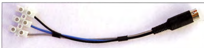
Adapter zum Anschluss eines eigenen Steuerkabels
