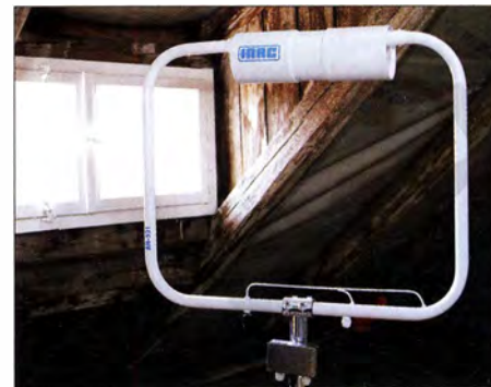
Unterdachbetrieb der AH-521
