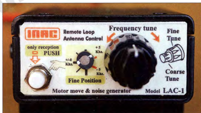
Steuergerät LAC-1 mit Doppelpotenzio- meter
