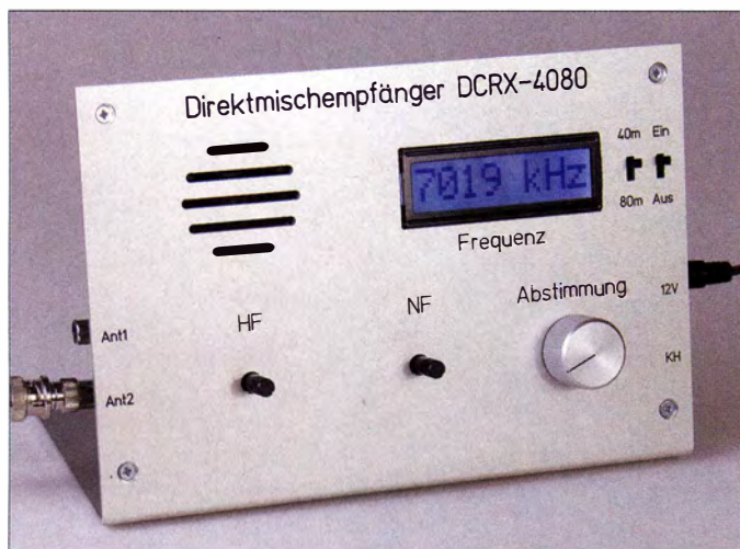
Bild 1: Frontansicht des fertig aufgebauten Direktmischempfängers für das 80-m- und das 40-m-Amateurfunkband; der Schiebeschalter unmittelbar neben dem LC-Display dient zur Bandumschaltung.
