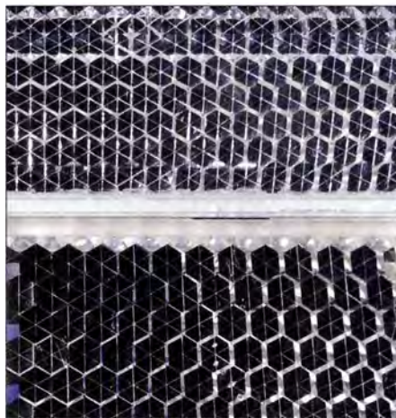
Bild 11: Reflexionsprismenspiegel unterschiedlicher Qualität; oben ein preiswerter Spiegel, unten ein hochwertiger Industriemirrorspiegel Fotos: DL1MK
