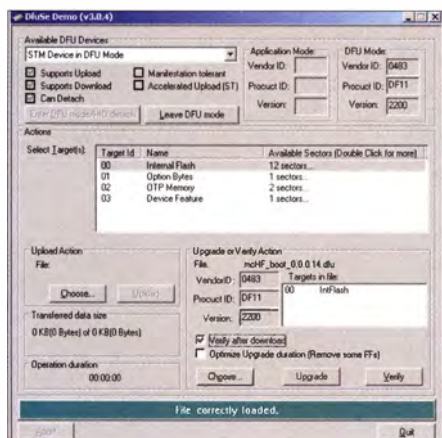
Bild 12: Das Einspielen des Bootloaders ist der erste Schritt der Programmierung des Mikrocontrollers. Er ist nur bei der Inbetriebnahme erforderlich.
